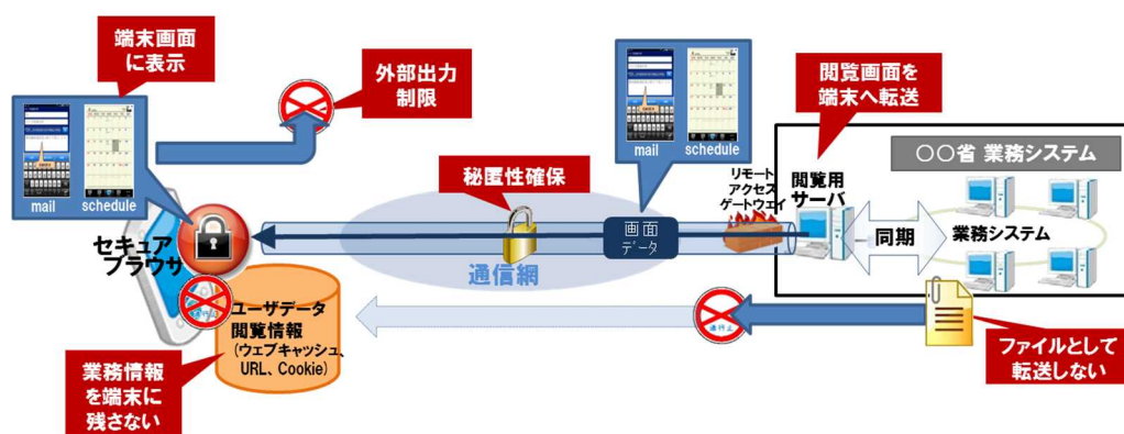
図 8.2.1-2 セキュアブラウザ活用型ソリューションのシステム構成例
