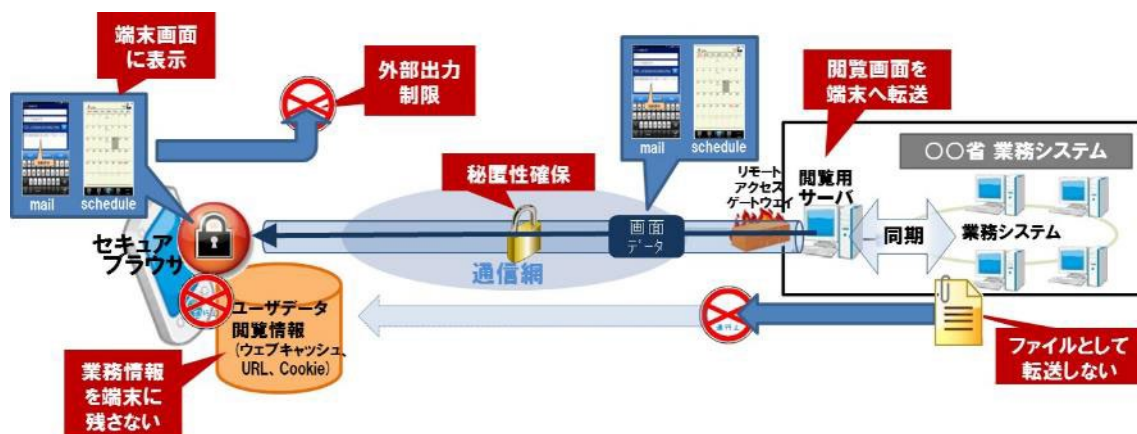
図 6.1.2-2 セキュアブラウザ活用型ソリューションのシステム構成例
